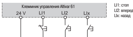
Схема соединений при трехпроводном управлении
