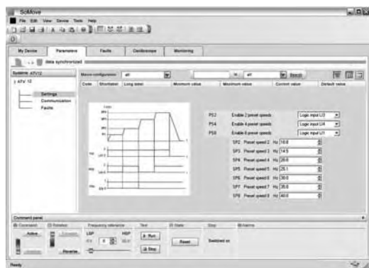
Настройка заданных скоростей с помощью ПО SoMove
