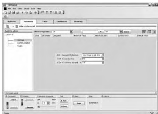
Настройка функции динамического торможения с помощью программного обеспечения SoMove
