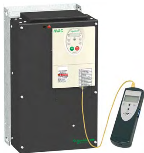
Конфигурирование преобразователя частоты Altivar 212 при помощи мультизагрузчика
