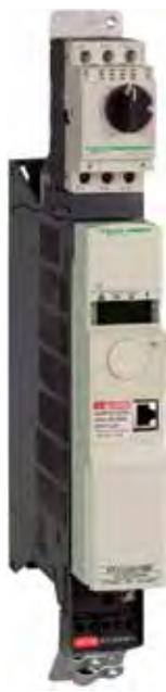
Прямое крепление автоматического выключателя GV2 к преобразователю частоты ATV 32: GV2 L08 + (VW A9 921 + GV2 AF4) (3) + ATV 32H075N4
