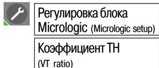
Если напряжение сети превышает 690 В, то для подачи цепей напряжения к Micrologic необходим понижающий измерительный трансформатор напряжения.
