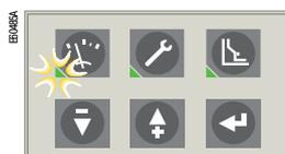
*Зажигание индикатора A<sub>p</sub> "autoprotection" - «самозащита» – сопровождается отключение автоматического выключателя при:*
