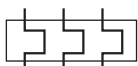
↑ Рис. 9 Тепловое реле с биметаллическим расцепителем LDR (Schneider Electric) и его схема
