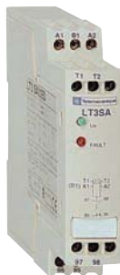
↑ Рис. 15 Электронное устройство LT3 Schneider Electric, к которому могут быть подключены три термистора, предназначенное для управления остановкой двигателя при перегреве
